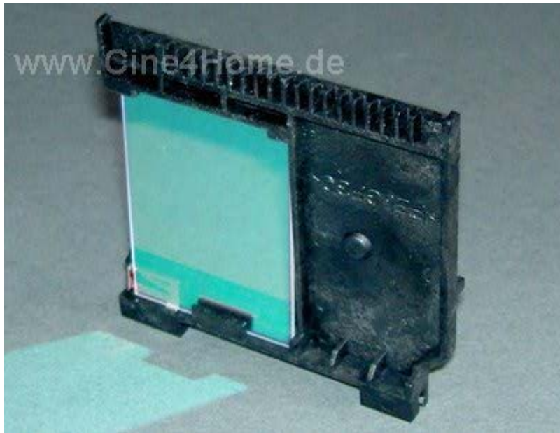
Der eingebaute Farbfilter des TW600
