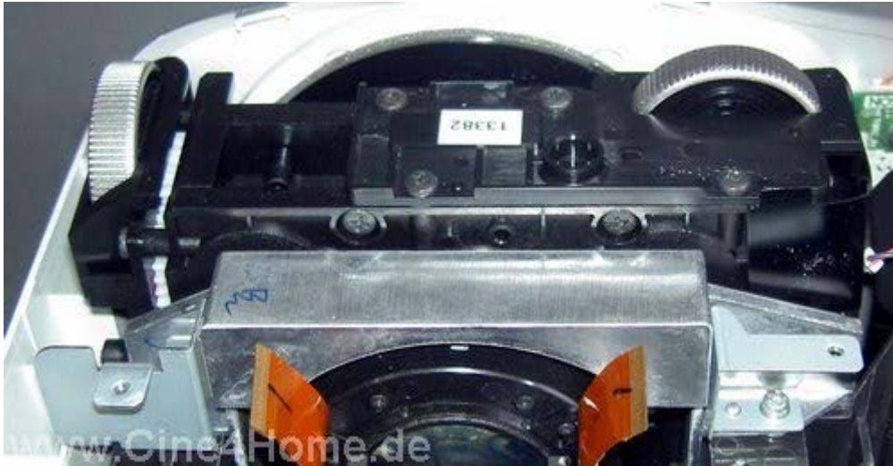
Die gut verkapselte Lens-Shift Mechanik
