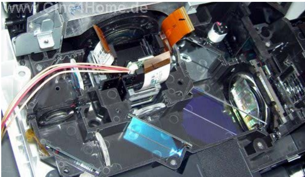
Auf dem Prisma ist der Temperaturfühler
