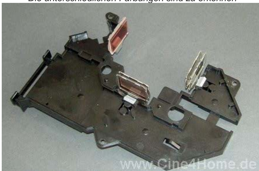
Die Polfilter vor den LCDs, Die unterschiedlichen Färbungen sind zu erkennen
