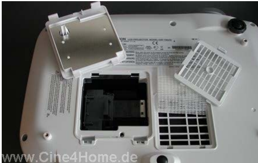
Der Luftfilter befindet sich auf der Unterseite des Projektors, direkt neben dem Lampenschacht (rechts)
