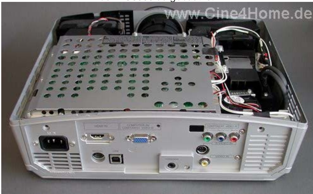
Der Blick ins Innere zeigt, wie kompakt und hochwertig der HC3000 aufgebaut ist.
