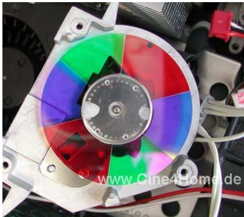
Das Farbrad des HC3000 mit vergrößerten Rot-Segmenten
