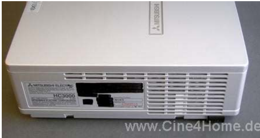
Rund um das Gerät: Kühlluft-Schlitze
