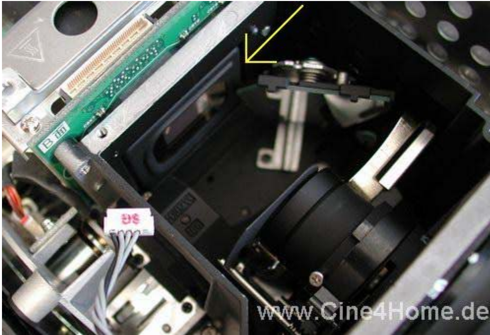
Die Lichtkammer aus anderem Blickwinkel, mit sichtbarem DMD Chip (Pfeil)
