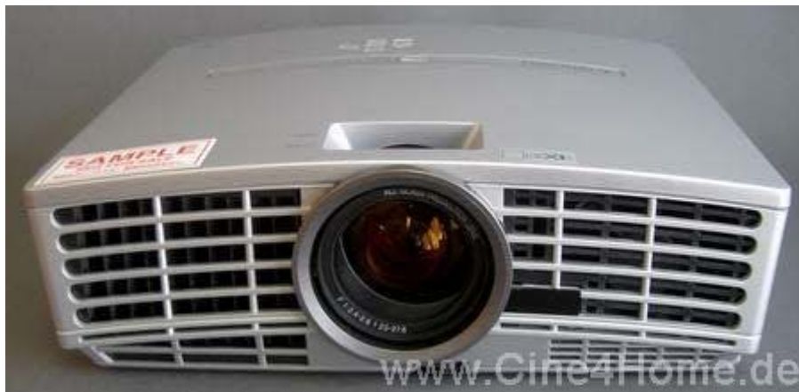
Rund um das Gerät: Kühlluft-Schlitze
