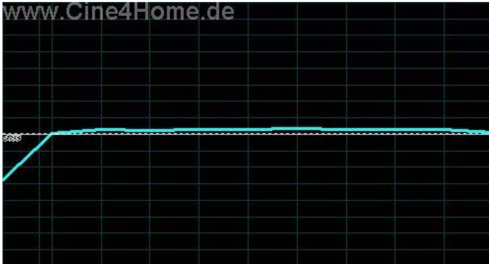
Die Farbtemperatur liegt fast punktgenau bei 6500K / D65
