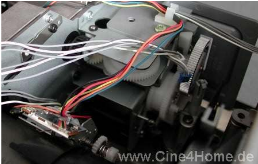
Aufwändige Lens-Shift Mechanik verbessert den Komfort
