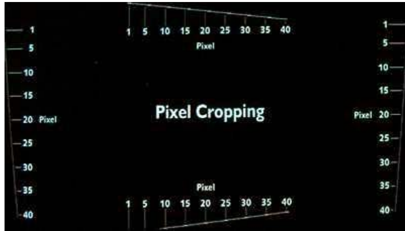
Der regelbare Overscan, von abgeschaltet (oben) bis ca. 25 Pixel auf jeder Seite (unten)
