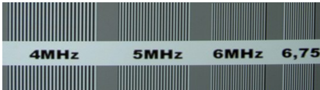
Burst-Testsignal, einmal digital zugespült (oben), einmal analog (unten)
