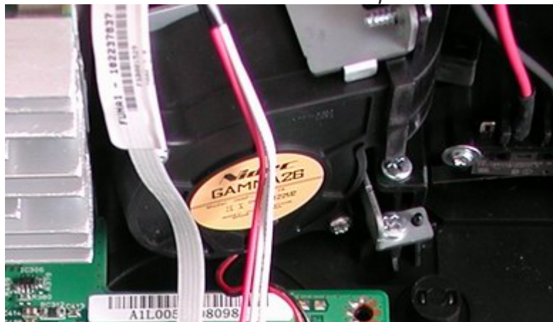
Der zusätzliche Lüfter am Lampenschacht
