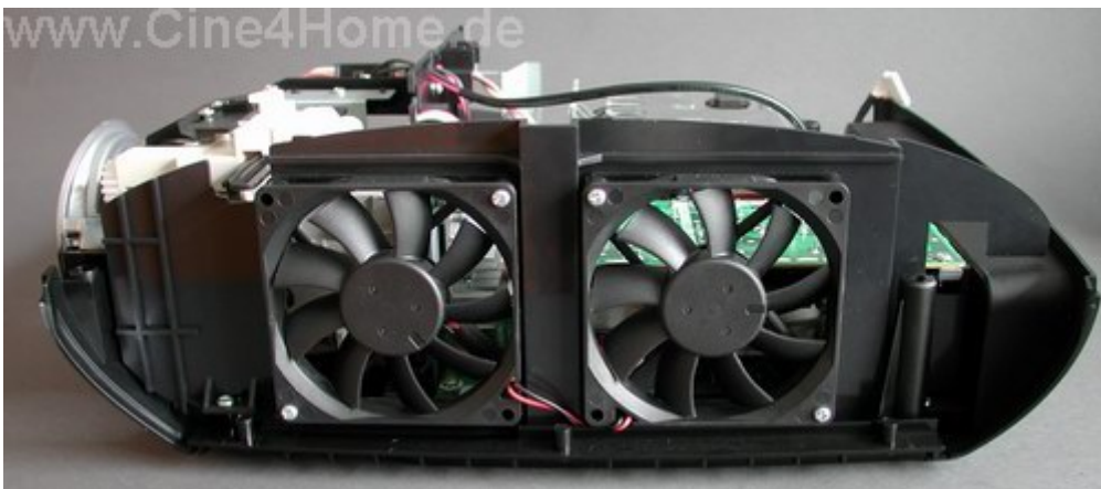
Zwei große Lüfter auf der linken Seite sorgen für die notwendige Kühlluft
