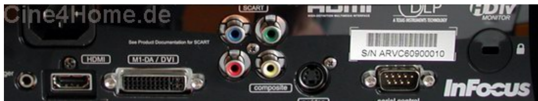
Die Anschlüsse des BlayBig-Beamers
