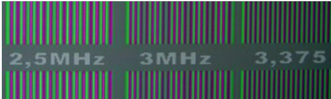
Farbauflösung, digital (oben) und analog (unten)
