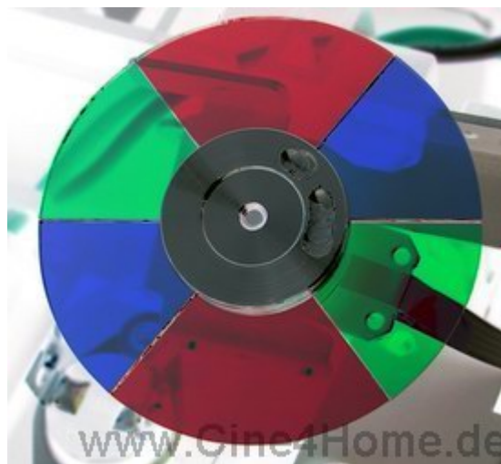
"Korrekte" Farben des Farbrades
