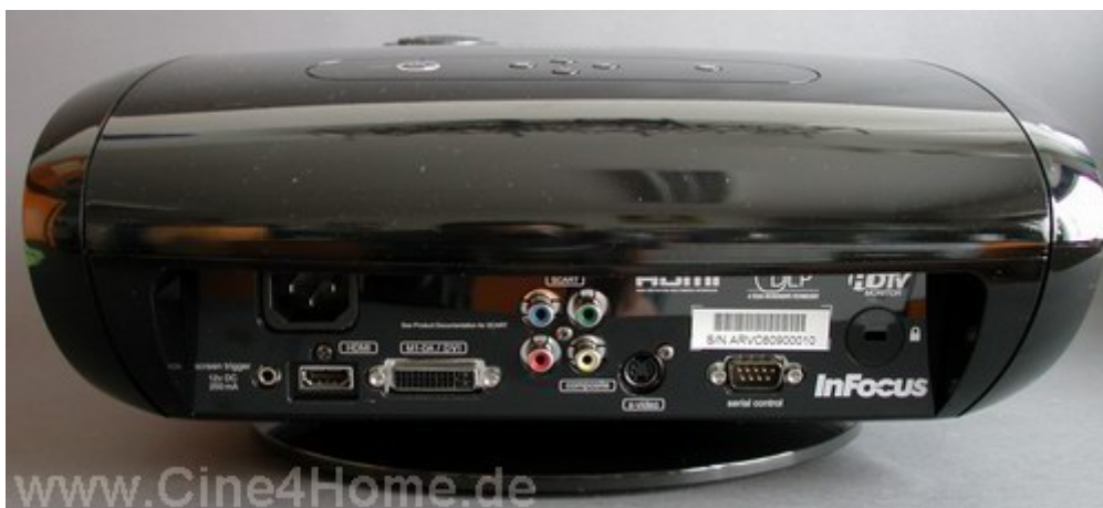
Die Rückseite mit allen Anschlüssen
