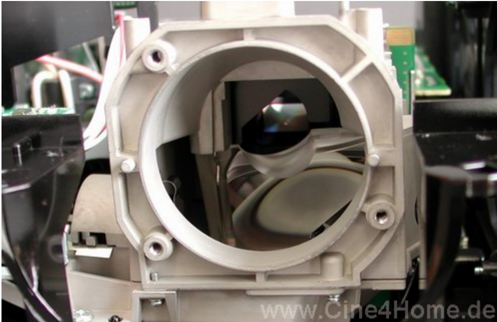
Die Fokussier-Linse mit dahinter liegendem DMD-Chip und "Lichtaustrittsloch"
